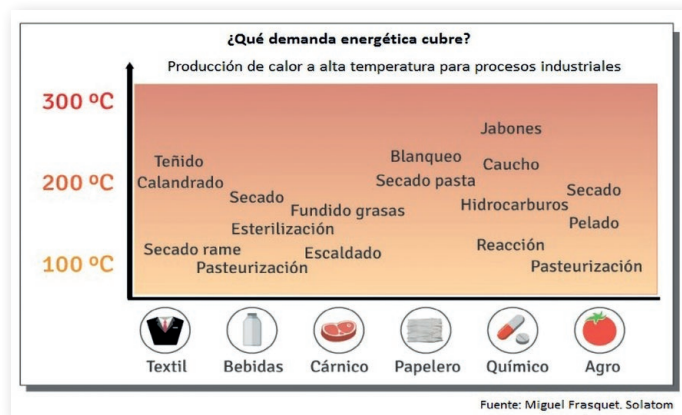
Instalación termosolar Fresnel para generación de vapor en Heineken Quart de Poblet (Valencia). Arriba, demandas energéticas que cubre la termosolar en los procesos industriales
