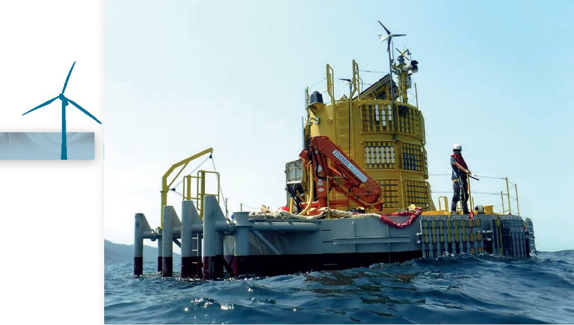
Laboratorio flotante HarshLab, desarrollado por la vasca Tecnalia y desplegado en la zona de ensayos en mar abierto de BiMEP, frente a las costas de Vizcaya
