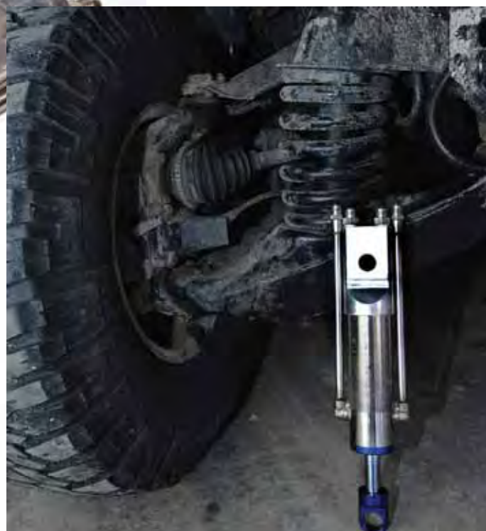
Los creadores de la empresa Levant Power Corp (debajo) han diseñado este amortiguador que genera electricidad dentro del automóvil cada vez que hace un movimiento de flexo-extensión.
