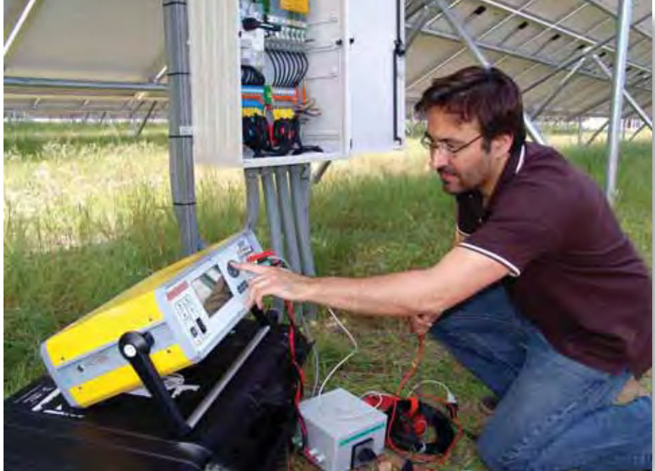
Arriba, ajustando el caracterizador, uno de los instrumentos clave en el fieldCheck. A la derecha, midiendo la potencia real de los módulos fotovoltaicos
