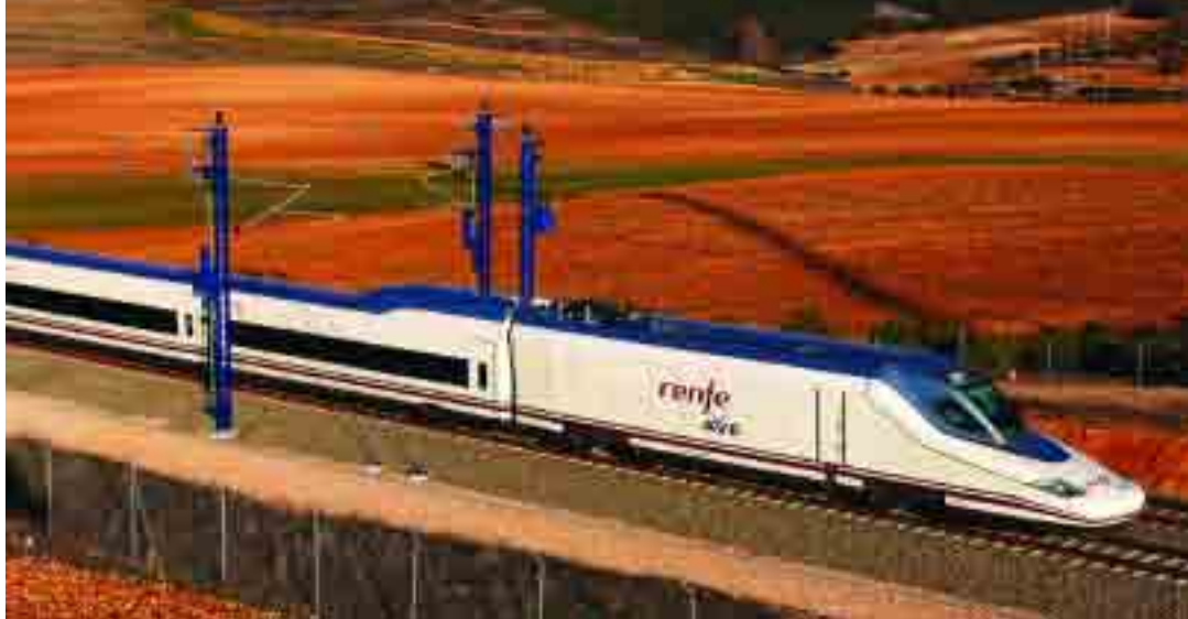
Los trenes de alta velocidad disponen de frenos regenerativos capaces de recuperar entre el 6 y el 10% de la energía que consumen y devolverla a la red eléctrica.
