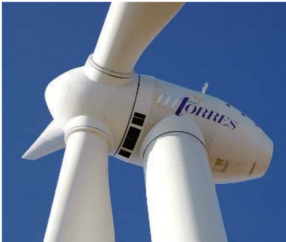
El TWT 1650 es un aerogenerador multipolo; no lleva multiplicador ya que el generador va acoplado directamente al rotor de la turbina. De momento es la única máquina de estas características que se fabrica en España.
