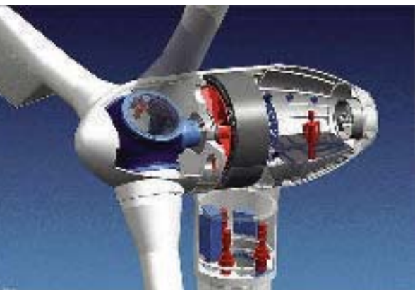
El TWT 1650 es un aerogenerador multipolo; no lleva multiplicador ya que el generador va acoplado directamente al rotor de la turbina. De momento es la única máquina de estas características que se fabrica en España.
