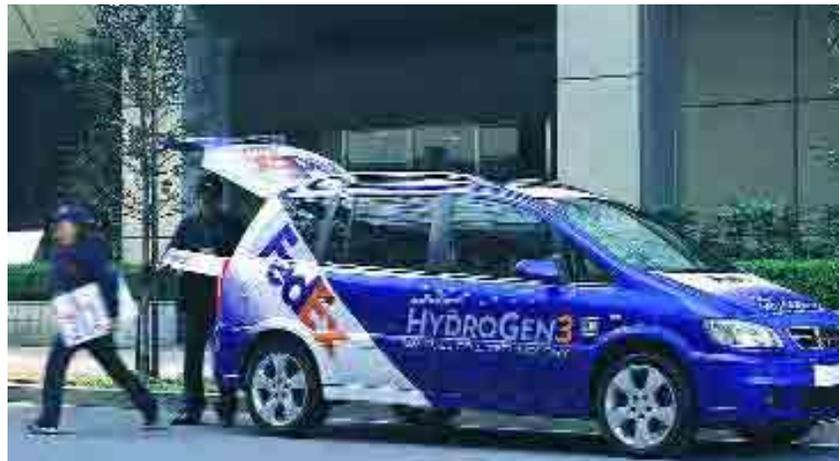
Con el hidrógeno de sus dos depósitos puede recorrer casi 150 km, a una velocidad máxima de 140 km/h.
